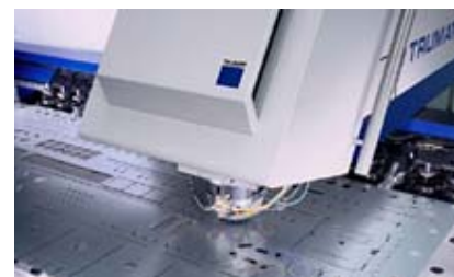
Fotos: TRUMPF GmbH + Co. KG Stanzkopf Der um 360 Grad drehbare Stanzkopf der TRUMATIC 5000 ROTATION erlaubt schnelle Hubfolgen beim Stanzen und Signieren. Er garantiert Qualität, Leistungsfähigkeit und Flexibilität bei Einzelteilen und Serien.
