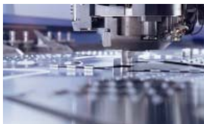
Fotos: TRUMPF GmbH + Co. KG Stanzkopf Der um 360 Grad drehbare Stanzkopf der TRUMATIC 5000 ROTATION erlaubt schnelle Hubfolgen beim Stanzen und Signieren. Er garantiert Qualität, Leistungsfähigkeit und Flexibilität bei Einzelteilen und Serien.
