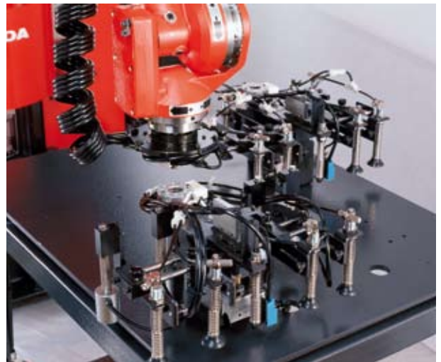
Bei der neuen Astro Plus können der Handhabungs- und der Biegeroboter die Greifer automatisch wechseln.
