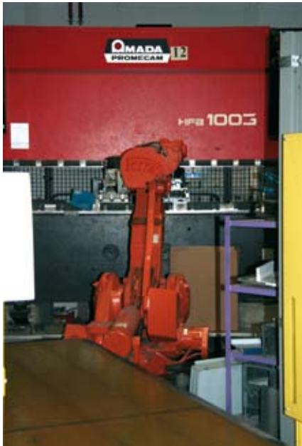
Die erste Biegezone von BVS – eine Kombination von Amada-Abkantpresse und ABB-Standard-Industrieroboter – läuft seit sechs Jahren absolut zuverlässig rund um die Uhr. Durch die aufwändige Programmierung nutzt BVS dieses System für große Serien.
