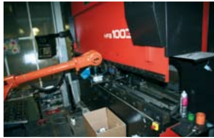
Die erste Biegezone von BVS – eine Kombination von Amada-Abkantpresse und ABB-Standard-Industrieroboter – läuft seit sechs Jahren absolut zuverlässig rund um die Uhr. Durch die aufwändige Programmierung nutzt BVS dieses System für große Serien.
