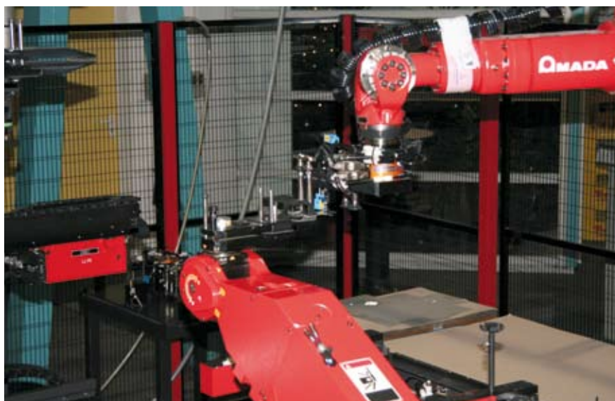
Hand in Hand: Der Handhabungsroboter übergibt dem Biegeroboter die zentrierte Platine.
