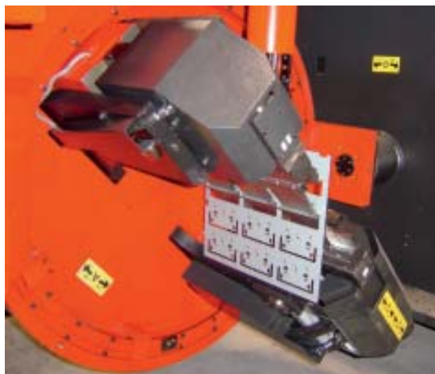
Der Handlingroboter führt den Mehrfachnutzen vertikal hängend zwischen die Biegewerkzeuge. Stempel und Matrize fahren an die Teile heran und formen sie in einer rotierenden Bewegung um
